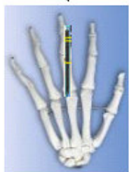
圖 3.彎曲感測器放置於手部關節剖析圖
