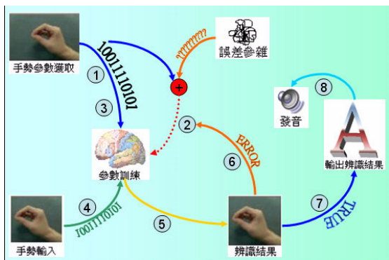
圖 12. 辨識演算法系統訓練流程圖
