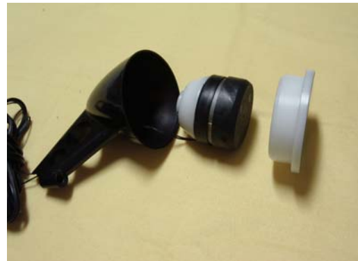
圖八、馬達及馬達座與鏡片座之實物組裝
