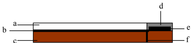
圖 8 整流天線剖面圖，a 為 Al_2O_3 板，b 為天線 pattern，c 為 RO 基板，d 為膠，e 為整流電路，f 為 feed 點。
