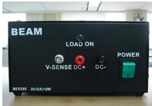
圖4：合作廠商所設計電子負載機之原型。
