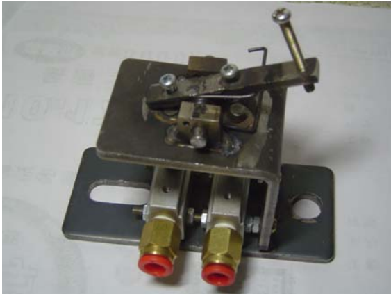
圖 8 水平調整閥(leveling valve)機構圖
