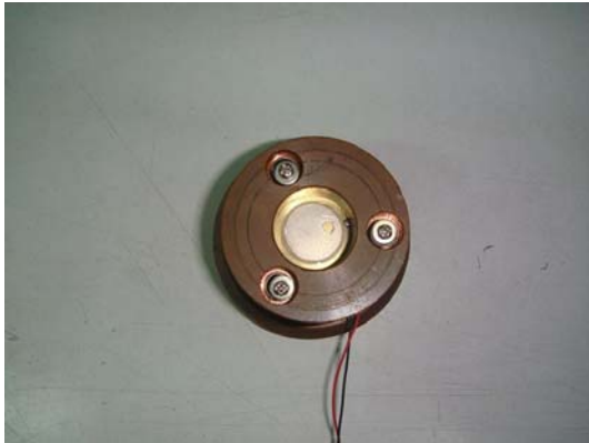
圖十、自製加速規上視圖
