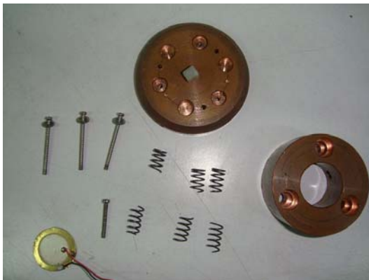
圖十二、自製加速規分解圖
